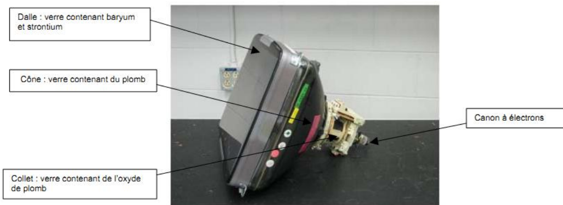
Figure 4.3 Les principaux composants d'un tube cathodique Tirée de CRIQ, 2009, p. 7.
